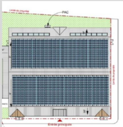
La surface totale de la toiture est d'environ 1 420 m<sup>2</sup> avec une pente de l'ordre de 14%.
